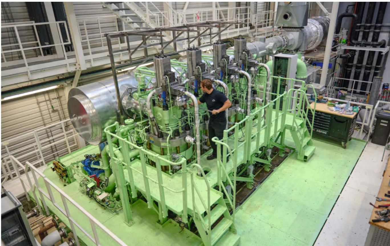
MAN-Teststand für Schiffsmotoren in Kopenhagen. Zu sehen sind hier die Zylinderköpfe, die für eine Umrüstung auf Ammoniak komplett ausgetauscht werden müssen. Die Kurbelwelle befindet sich zwei Stockwerke tiefer.
