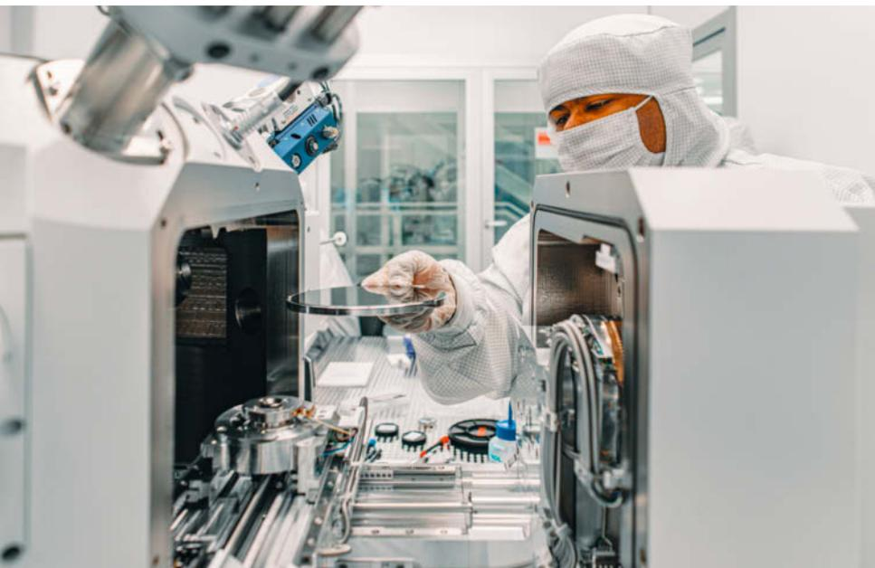
Nicht nur große Konzerne wie IBM und Google arbeiten an Quantencomputern. In Finnland entwickelt und produziert IQM eigene supraleitende Quantenschaltkreise.
